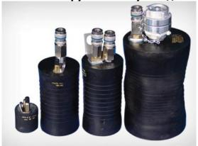
Данные заглушки в основном используются для уплотнения при канализационных подключениях. Используются также при испытании герметичности трубопроводов. Заглушки изготавливаются из качественной резины, а металлические элементы из антикоррозийных материалов. Стандартная типовая серия изготавливается с диаметрами от 30 до 650 мм. Применяются для тестирования воздухом или водой.
