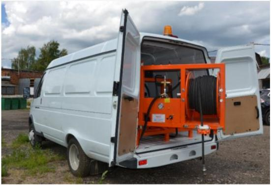
Автономная каналопромывочная машина на шасси **ГАЗель 2705** отличается более высокой мобильностью по сравнению с классическими профильными спецавтомобилями, предназначена для очистки труб хозяйственно-бытовой, ливневой и технологической канализации диаметром **от 100 до 600 мм на длину до 120 м**.
