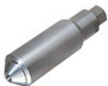
Форсунка роторная Турбофреза 1200 бар, очень эффективный аксессуар для выполнения работы совместно с гидродинамической машиной Преус для очистки поверхностей. Благодаря подвижной водяной струе, которая вращается по кругу и образует очищающий конус происходит очистка. Применяется для очистки больших сильнозагрязненных площадей с высокой скоростью и эффективностью очистки.
