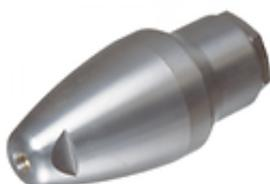
Форсунка роторная Турбофреза 500 бар, очень эффективный аксессуар для выполнения работы совместно с гидродинамической машиной Преус для очистки поверхностей. Благодаря подвижной водяной струе, которая вращается по кругу и образует очищающий конус происходит очистка. Применяется для очистки больших сильнозагрязненных площадей с высокой скоростью и эффективностью очистки.
