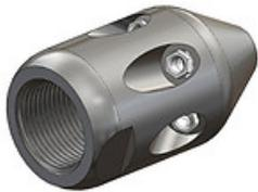
Форсунка очистная 3x25 гр. 3x30 гр. назад, 1x0 гр. вперед 1/2" BSP (Г) высокоэффективная насадка для устранения сложных засоров.
