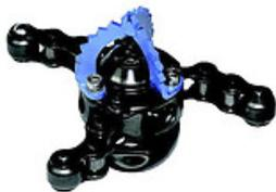
Форсунка цепная для прочистки труб Spider (Паук) 50, с легкостью справляется с корнями деревьев проросшимив трубы. Вращающиеся цепи срезают и измельчают корни, а задние струи воды вымывают их из трубы.
