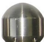
Очистная форсунка 6 x 30 град. назад 1 x 0 град. вперед 1/2" 50 л/мин BSP (Г) каналопромывочная улучшенная. Используется с каналопромывочными установками для плановой промывки канализационных труб и устранения не сложных засоров.
