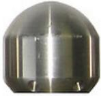
Очистная форсунка 6 x 30 град. назад 1 x 0 град. вперед 1/2" 75 л/мин BSP (Г) каналопромывочная улучшенная. Используется с каналопромывочными установками для плановой промывки канализационных труб и устранения не сложных засоров.
