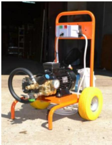
Электрический опрессовщик предназначен для проведения испытаний, гидравлической опрессовки различных систем, таких как трубопровод, система отопления, котел, емкость, водопровод и тд. Опрессовочный насос Е-ГС позволяет быстро и максимально точно создать требуемое давление в опрессовываемой системе, в диапазоне от 50 до 200 бар.
