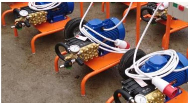
Электрический опрессовщик предназначен для проведения испытаний, гидравлической опрессовки различных систем, таких как трубопровод, система отопления, котел, емкость, водопровод и тд.
