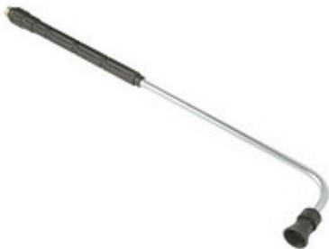
Предназначен для использования с распылительным пистолетом для удлинения его и подачи чистой воды. Сделана из нержавеющей стали. Рабочее давление до 350бар. Расход воды до 50 л/мин. Максимальная температура воды до 160°C. Не требует тех. обслуживания и не подлежит ремонту. В случае механических повреждений подлежит замене.
