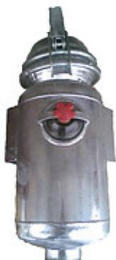
предназначена для задержки крупных частиц при откачке ила из канализационных систем. Изготовлены из металла, присоединяются к напорно-всасывающему шлангу диаметром 100 мм. Имеет смотровое окошко для контроля уровня загрязненности. На насадке имеются сверху крышки для извлечения засорения
