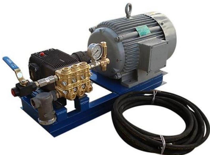
Электрические устройства для опрессовки сосудов и труб обеспечивают точную и быструю проверку давления, а также герметичности трубопроводных систем и резервуаров в водопроводных и отопительных системах, в паровых и масляных установках и пр. Аппараты для опрессовки трубных систем снабжены запорным краном высокого давления, позволяющим запереть систему после заполнения и отключить аппарат.
