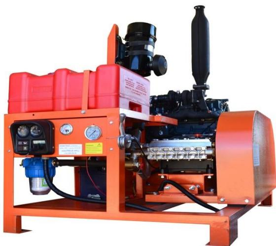
Аппарат высокого давления **Д5030** с дизельным двигателем Kubota, рабочим давлением 500 бар с потоком воды 30 л/мин (1800 л/час), обеспечивает эффективную гидродинамическую очистку любых поверхностей и труб, может быть применен для мойки и очистки фасадов зданий, водопескоструйной очистки и т.д. Оснащен высококачественным итальянским насосом высокого давления компании UDOR, что обеспечивает превосходную надежность и производительность.
