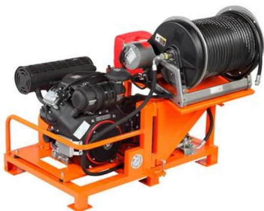
Каналопромывочная машина Б1550КР-Е на раме с электрическим приводом барабана, оснащается бензиновым двигателем. Установленный двигатель не прихотил в работе, легок с обслуживанием, запуск осуществляется с помощью стартера, что делает работу еще удобнее. Итальянский плунжерный насос высокого давления, обеспечивает превосходную надежность и производительность, максимальное рабочее давление каналопромывочная машина Б1550КР-Е составляет 150 бар с потоком воды 50 л/мин (3000 л/час).
